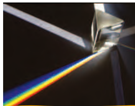
Fig. 12. Espectro continuo de la luz blanca. Es el resultado de la “descomposición” de un haz de luz al pasar a través de un prisma.
